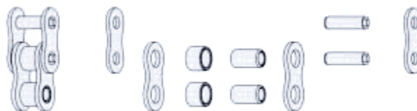
Fig. 1 - Schema di accoppiamento tra maglia interna e maglia esterna Pict.1 – Scheme of connection between inner link and pin link
